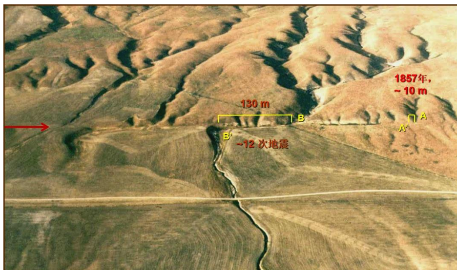
图8 美国圣安德列斯断裂上的累积位移与同震位移（Robert E. Wallace 摄）。圣安德列斯断层是世界上著名的活断层，该断裂上地震重复发生，每次地震产生的位移均为10米左右，为特征位移。A与A'点对应的溪
