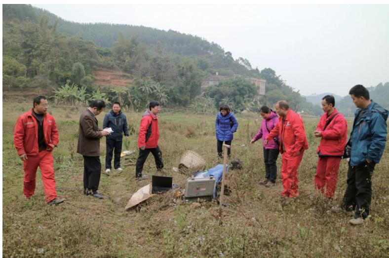
广西灵山地震区大地电磁探测野外测量
