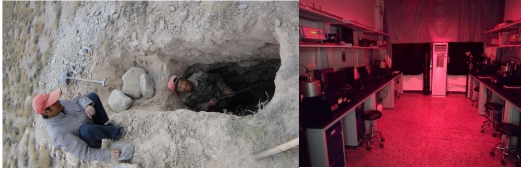
图7 释光样品野外采集（左图）与实验室处理（右图）
